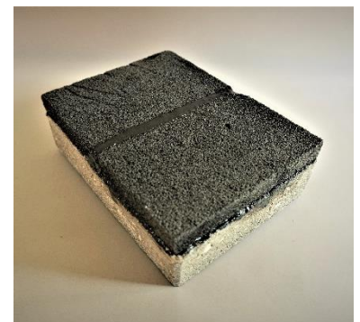
Abb. 49 Muster Bitumenersatz 2 Wynigen Foto, 08.08.2020
