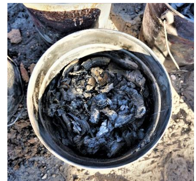
Abb. 20 Rindenkohle in Schmelbehälter nach Pyrolyse Langetschwand Wyssachen Foto, 23.04.2020
